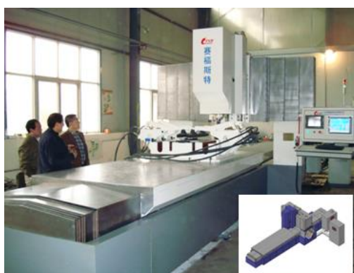
图 12-8 中国搅拌摩擦焊中心为长春客车厂研制的搅拌摩擦焊设备
