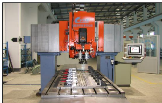
图 12-6 中国搅拌摩擦焊中心研制的中国首台列车产品搅拌摩擦焊设备
