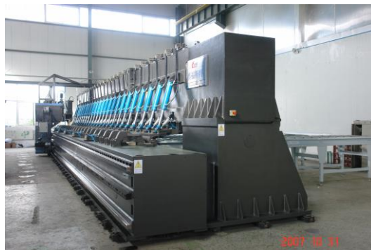
图 12-5 中国搅拌摩擦焊中心 2007 年研制的宽幅型材壁板搅拌摩擦焊设备
