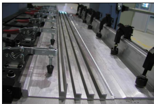
图 12-25 轨道车辆电源型材箱体搅拌摩擦焊
