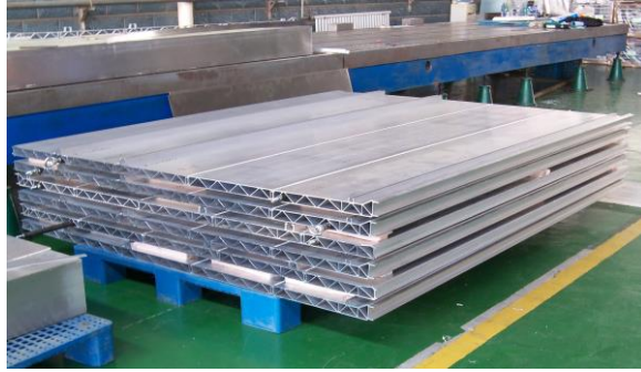
图 12-29 中空型材地铁列车侧墙壁板搅拌摩擦焊接
