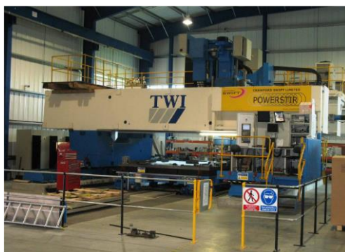
图12-4 英国PTG公司制造的焊接厚度100mm的大型搅拌摩擦焊设备
