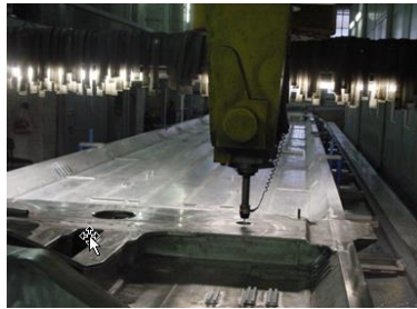
图 17-8 大型龙门铣加工底架示意
