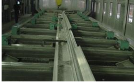
图 17-10 大型龙门铣加工边梁示意
