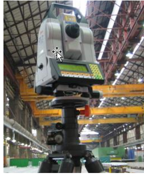
图 21-3 全站仪测量示意
