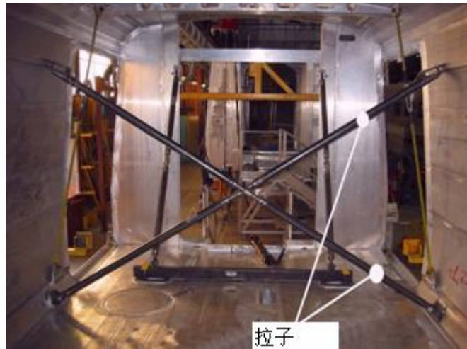
图 27-17 车体内部支撑示意
