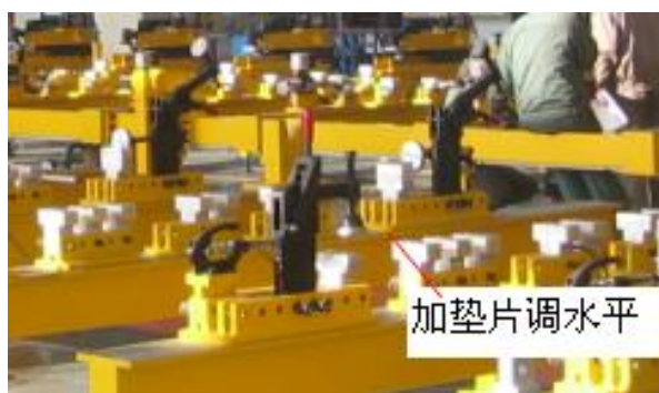
图27-3 工装加垫片示意
