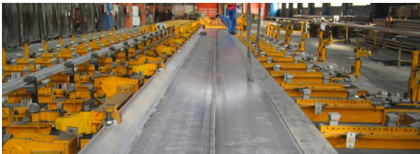
图 27-7 底架正装、反装卡具
