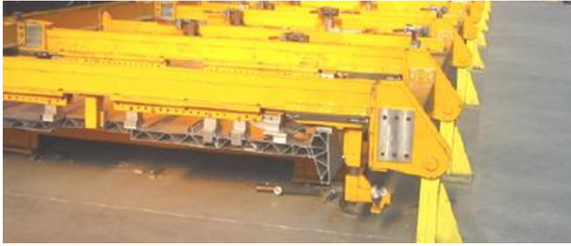
图 27-9 底架反装示意
