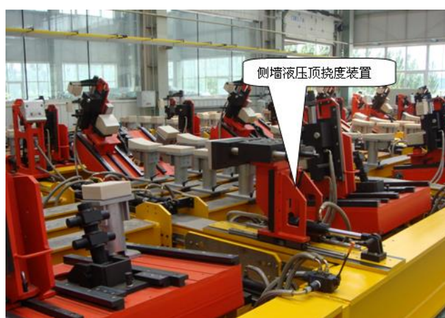
图27-4 液压顶挠度示意
