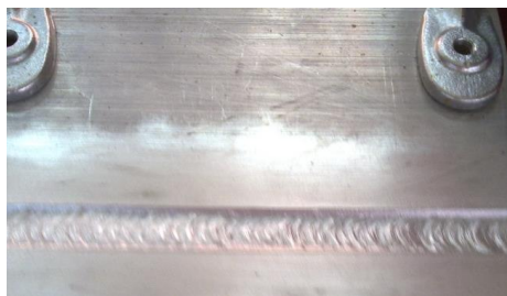
图 28-12 层间焊缝表面示意
