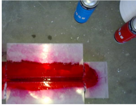
图 28-15 焊缝光化处理后层间检查示意
