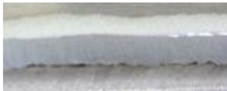
图 29-27 根部熔合良好示意
