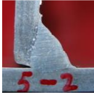
图 29-33 根部熔合较差的单道角焊缝宏观断口
