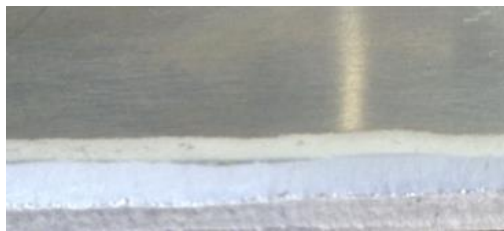
图 29-27 根部熔合良好示意
