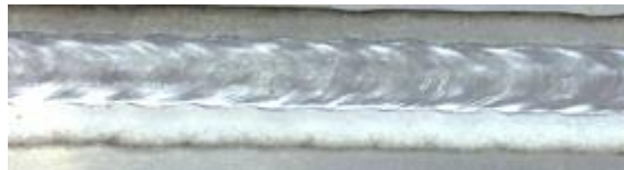
图 29-24 角焊缝合格的打底焊缝光洁度
