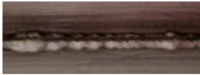
图 29-23 角焊缝打底焊道光滑不够，易造成次焊道未熔合缺陷
