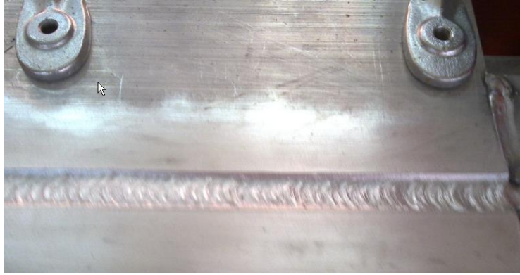
图 29-38 是第二层横摆焊接示意
