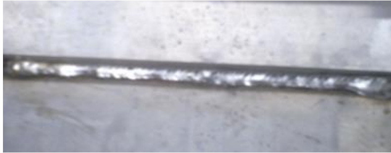
图 29-26 对接打底焊道不合格示意
