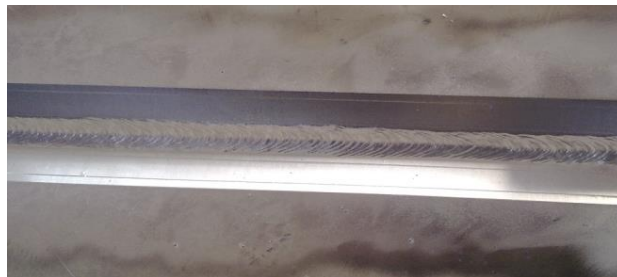
图 29-24 角焊缝合格的打底焊缝光洁度
