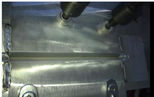
图 29-35 平焊位置单道对接焊接
