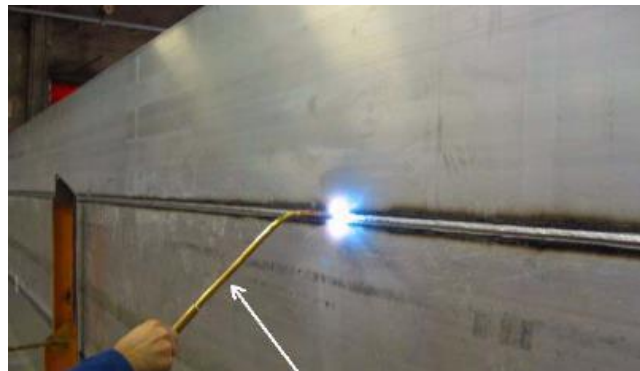
图 8-3 火焰调修大部件工作示意
