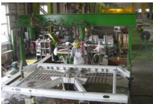
图 8-4 机械调修示意
